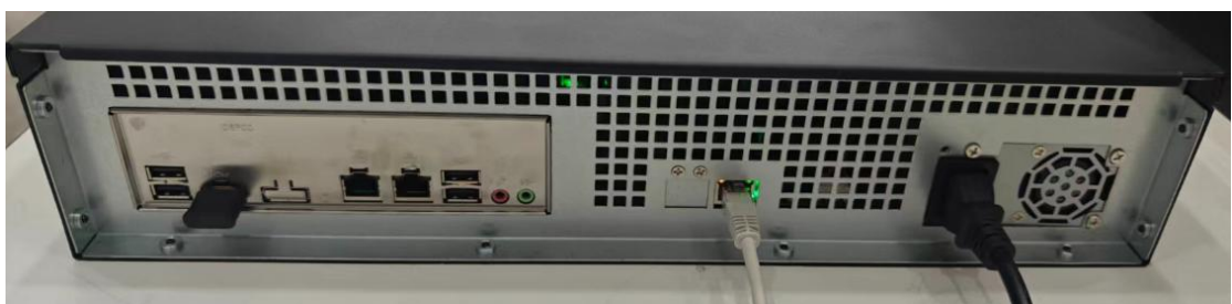
图 2-6 2U 边缘一体机连接方式
