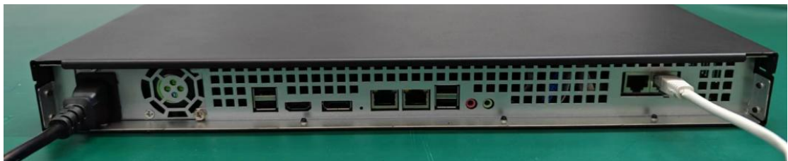
图 2-5 1U 边缘一体机连接方式
